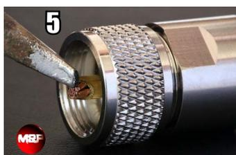
5 Inserire il connettore ed avvitare con cura, fino ad andare a serrare il componente A di battuta. All'interno del connettore, il cilindro di gomma C (figura 1) si espande garantendo un'ottimale tenuta contro l'umidità e una perfetta chiusura a massa.
