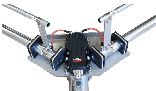
Nota: Al instalar el soporte de montaje del conjunto, preste atención a la diferenciación de los componentes aislantes de plástico. Los componentes de plástico con escalones deben colocarse en la parte inferior del conjunto.
