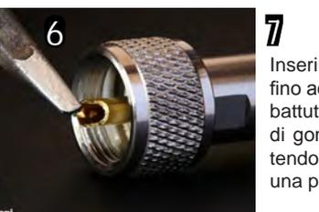
6 Inserire il connettore e successivamente saldare il conduttore centrale come in figura. Saldare lo spillo al conduttore centrale, inserendo stagno nell'apposito foro. Non scaldare troppo a lungo lo spillo per evitare che il rame sottostante conduca troppo calore tanto da deformare il dielettrico del cavo. (che è PE espanso e non in teflon!)
