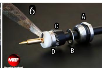
6 Inserire uno dei due dischetti in teflon e successivamente lo spillo centrale. Saldare lo spillo al conduttore centrale, inserendo stagno nell'apposito foro. Non scaldare troppo a lungo lo spillo per evitare che il rame sottostante conduca troppo calore tanto da deformare il dielettrico del cavo. (che è PE espanso e non in teflon!)
