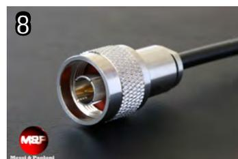
8 Inserire il connettore ed avvitarlo con cura, fino ad andare a serrare l'o-ring di battuta. All'interno del connettore, il cilindro di gomma C (figura 2) si espande garantendo un'ottimale tenuta contro l'umidità e una perfetta chiusura a massa.
