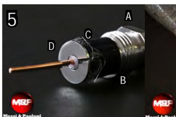
5 Tagliare e rimuovere il nastro e dielettrico per una lunghezza pari a quella illustrata sul calibro, liberando il conduttore centrale.
