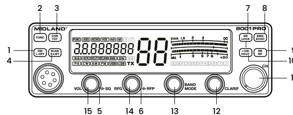
1. **Pulsante Dual Watch (DW)/L-OFF.** **Pressione breve:** monitora due canali contemporaneamente (DW). **Pressione lunga:** disattiva completamente il display (L-OFF).
